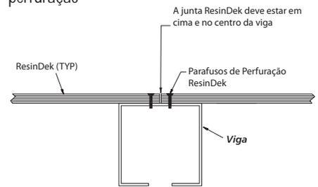
Figura B Instalação típica do ResinDek<sup>®</sup> Xspan<sup>®</sup>
